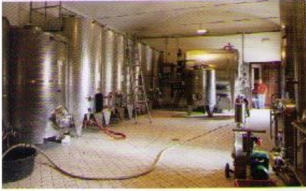
90年に改装した1階部分のセラー。温度コントロールできるステンレスタンクや、ロータリーファーマンターなど最新機器が揃う。
